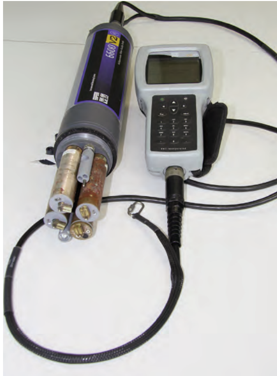
Abb. 8: Multisonde zur in situ – Messung mehrerer chemisch-physikalischer und biologischer Kenngrößen, Foto: S.K. Wanzenböck.
