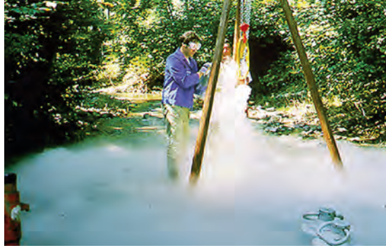
Abb. 12: Einsatz der Gefrierkern-Technik im Weidlingbach. Ein Metallrohr wurde 60 Zentimeter in das Sediment eingeschlagen und wird nun mit flüssigem Stickstoff (minus 196 °C) befüllt. Der beim Einfüllen entweichende Stickstoff kühlt die umliegende Luft teilweise unter den Taupunkt ab und erzeugt im Bachbett Nebel.
