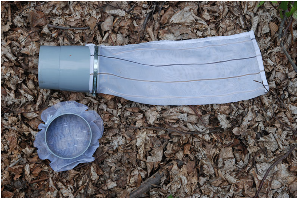
Abb. 8 Auswechselbarer Aufsatz mit Netz (oben) und passender Verschlusskappe (unten) (Foto: T. Glinka).
