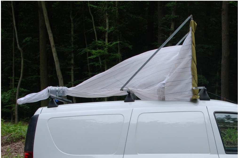
Abb. 2 Seitenansicht des montierten Autokeschers inklusive des am Aufnahmestück angebrachten Aufsatzes (Foto: T. Glinka).
