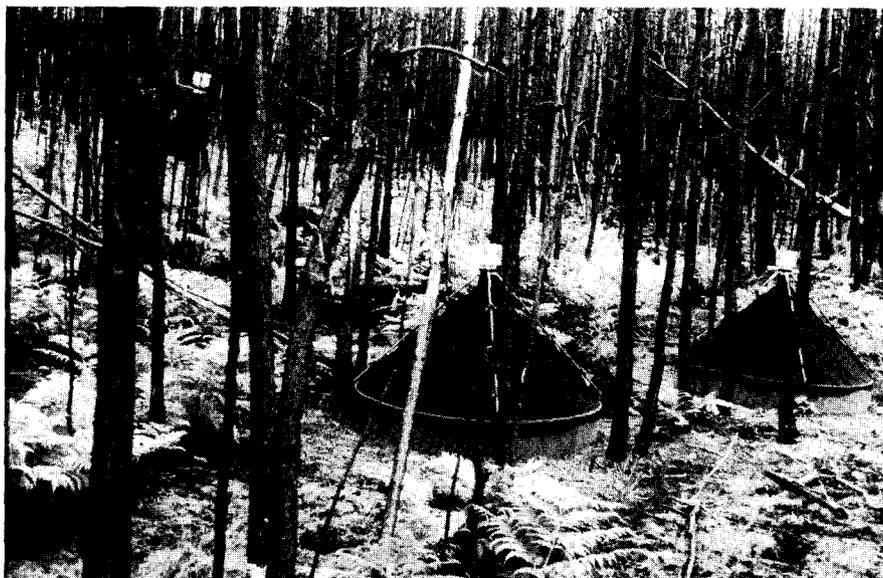
**Abb. 2:** Boden-Photoelektoren (Grundfläche 1 m<sup>2</sup>) in 20jährigen verbrannten Kiefernkulturen der Lüneburger Heide 1976. Zustand ein Jahr nach Feuereinwirkung. Je ein Gerät ist in Pflanzreihe und im Zwischenstreifen in den Mineralboden eingelassen.
