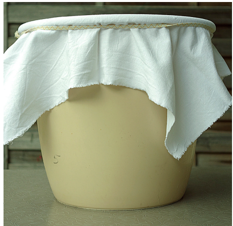
Abb. 16: Ausleseapparat in Betrieb. Der gefüllte Substratbehälter steht auf dem nach oben offenen Petrischalen-Unterteil, der Eimer ist mit Abdecktuch und Gummiband verschlossen.
