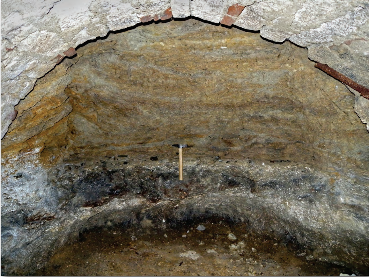
Abb.10: Aufschluss im Keller des Stadthotels Oppitz (ehemals Gasthof zur goldenen Sonne). Über groben Sanden mit Molluskenschill (Burgschleinitz-Formation) liegen feinkörnige Sande und Silte der Gauderndorf-Formation. Foto R. Roetzel, GBA Wien.
