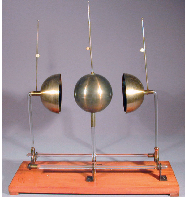
Abb. 3: Der Apparat nach Cavendish. Institutsanfertigung um 1800. Dieser Apparat diente zur Demonstration der Verteilung von elektrischen Ladungen auf Leitern.
