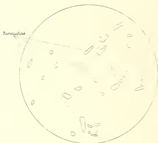
Tuffartiger Einschluss mit Turmalin im Porphyr am Ziegelwald. Vergr. c. 300fach.
