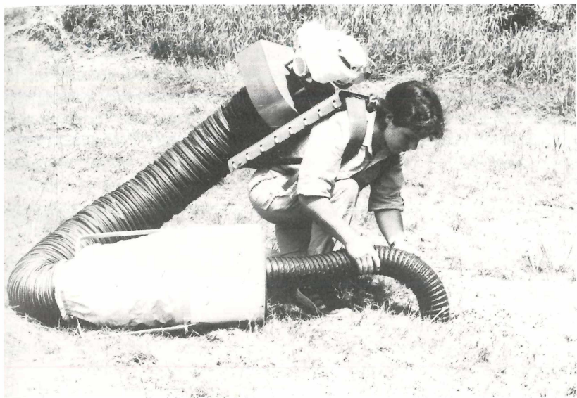
Abb. 7: Einsatz des „vacuum-insect-net“ (D-Vac) zum Absammeln von Arthropoden in der Krautschicht und auf der Bodenoberfläche. Das Gerät arbeitet nach dem Prinzip des Staubsaugers und wird mit einem Zweitaktmotor betrieben. Die eingesaugten Tiere bleiben lebend in einem Netzeinsatz hängen und können später aussortiert werden.
