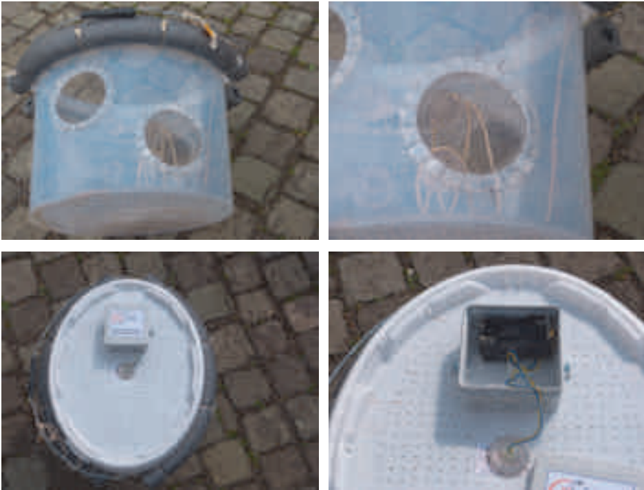
Abb. 10a-d: Handwerklich besonders sorgfältig hergestellte Eimerfalle der Biologischen Station Kreis Wesel. 10a: Die Falle hat vier seitliche Öffnungen, aber keine am Boden. 10b: Man beachte die Befestigung der Flaschenköpfe, deren Ränder umgebogen und „vernäht“ wurden. 10c: Zusätzlich ist eine Beleuchtungseinrichtung in der Mitte des Deckels angebracht. 10d: Die Beleuchtung ist hier unter einem Deckelchen eines Schnappdeckelgläschens montiert. Die beiden Batterien bzw. Akkus werden in einem gesonderten Kästchen, das auf dem Deckel angeschraubt ist, untergebracht. Fotos: M. Schlüpmann.
