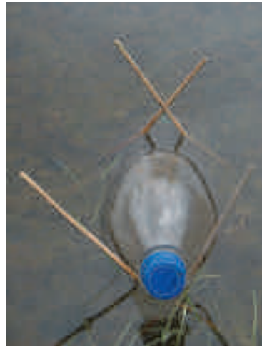
Abb. 4a: Die Auslegung der Flaschenreusen in Dreiergruppen erlaubt auch an dicht bewachsenen Ufern ein Wiederfinden aller Flaschen. Die Flaschen müssen am Ufer so aufgestellt werden, dass sie nicht abtreiben oder abrollen. Außerdem ist zu gewährleisten, dass ihre perforierte Wandung aus dem Wasser ragt. Die Flasche wird mittels zwei ggf. auch drei bis fünf Blumenhölzchen fixiert.
