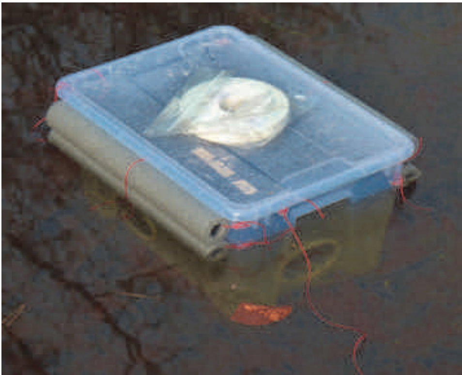
Abb. 18: Sehr stabile, transparente Schachtfallen mit abnehmbarem Deckel, einsetzbar in flachen und tieferen Gewässerbereichen, ohne und mit batteriebetriebener LED-Beleuchtung, a) hohe und flache Schachtfalle, b) LED-Beleuchtung auf einer Schachtfalle. Fotos: A. Kronshage
