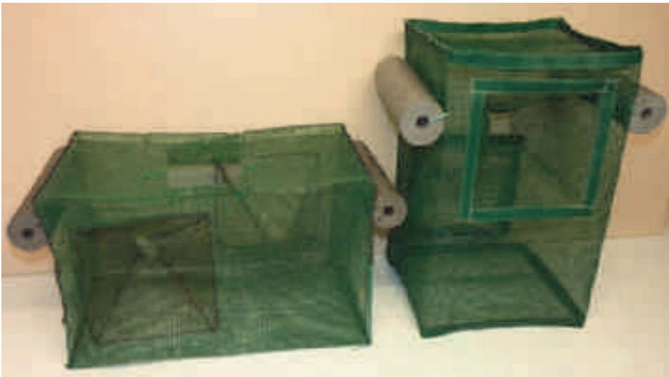
Abb. 6: Gaze-Kastenreusen in horizontaler Ausrichtung (Modell I links) und in vertikaler Ausrichtung (Modell II rechts). Foto: A. Kronshage
