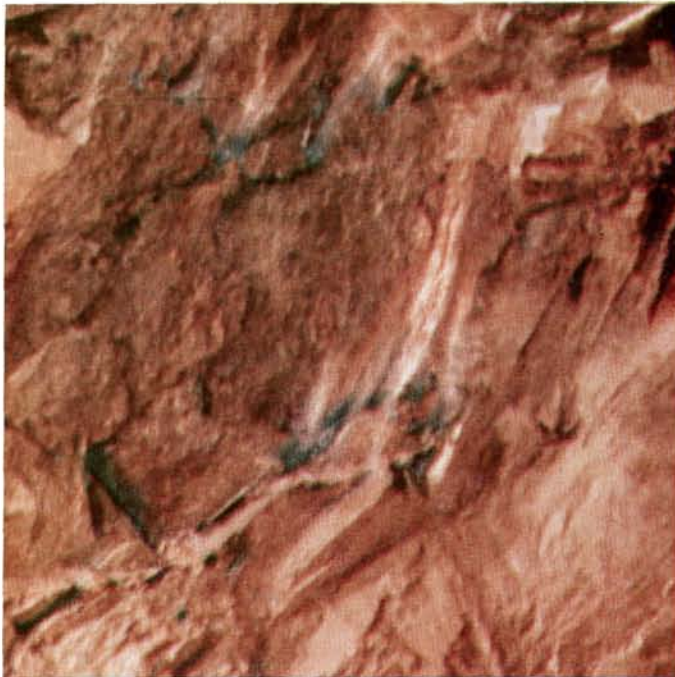
Abb. 38. Brand der Salinargase im Südtrum bei Station 1383. Bläuliche Flammen über den Schichtfugen, gelbbraune Verfärbung des hellgrauen Anhydrits durch Hitzeentwicklung.
