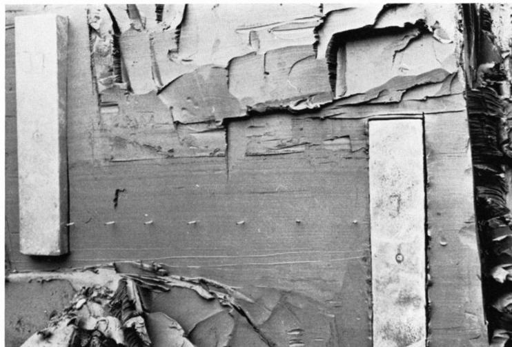
Abb. 3 Überlappung von Entnahmekästen
