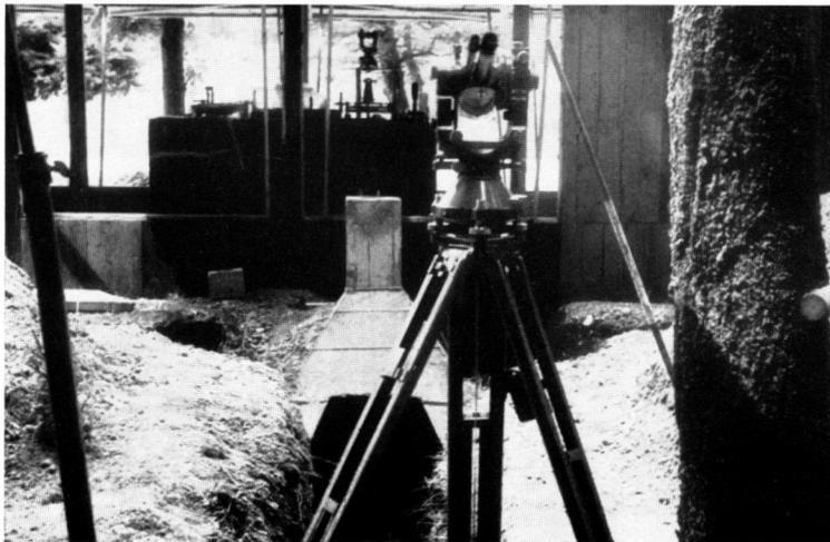
Fig. 11. Unterirdische Festlegungen. JÄDERIN-Interferenzpfeiler
