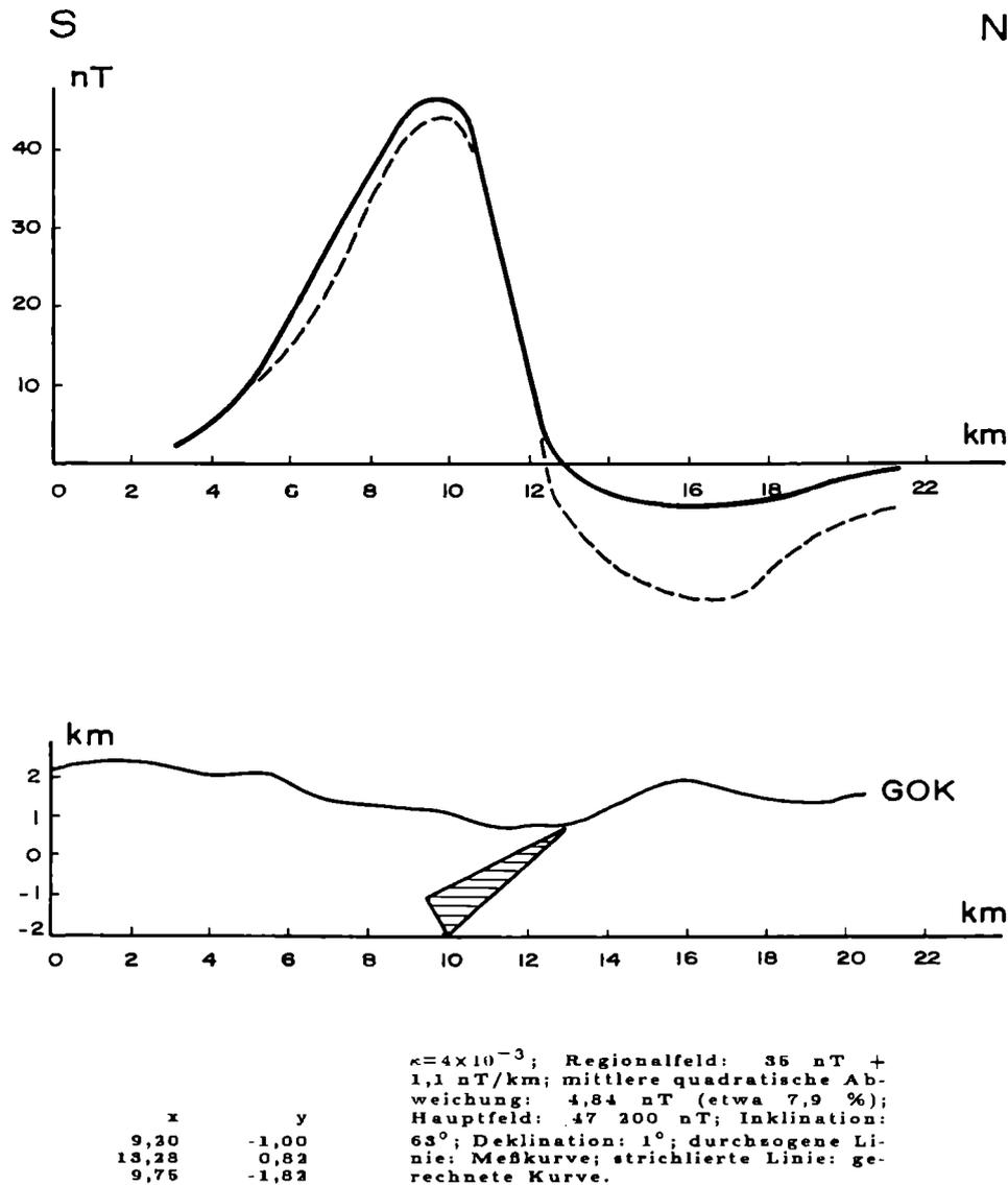
Abb. 12/2: Modellrechnung für Profil 1 in Abb. 12/1 mit zugehörigen Störkörper.
