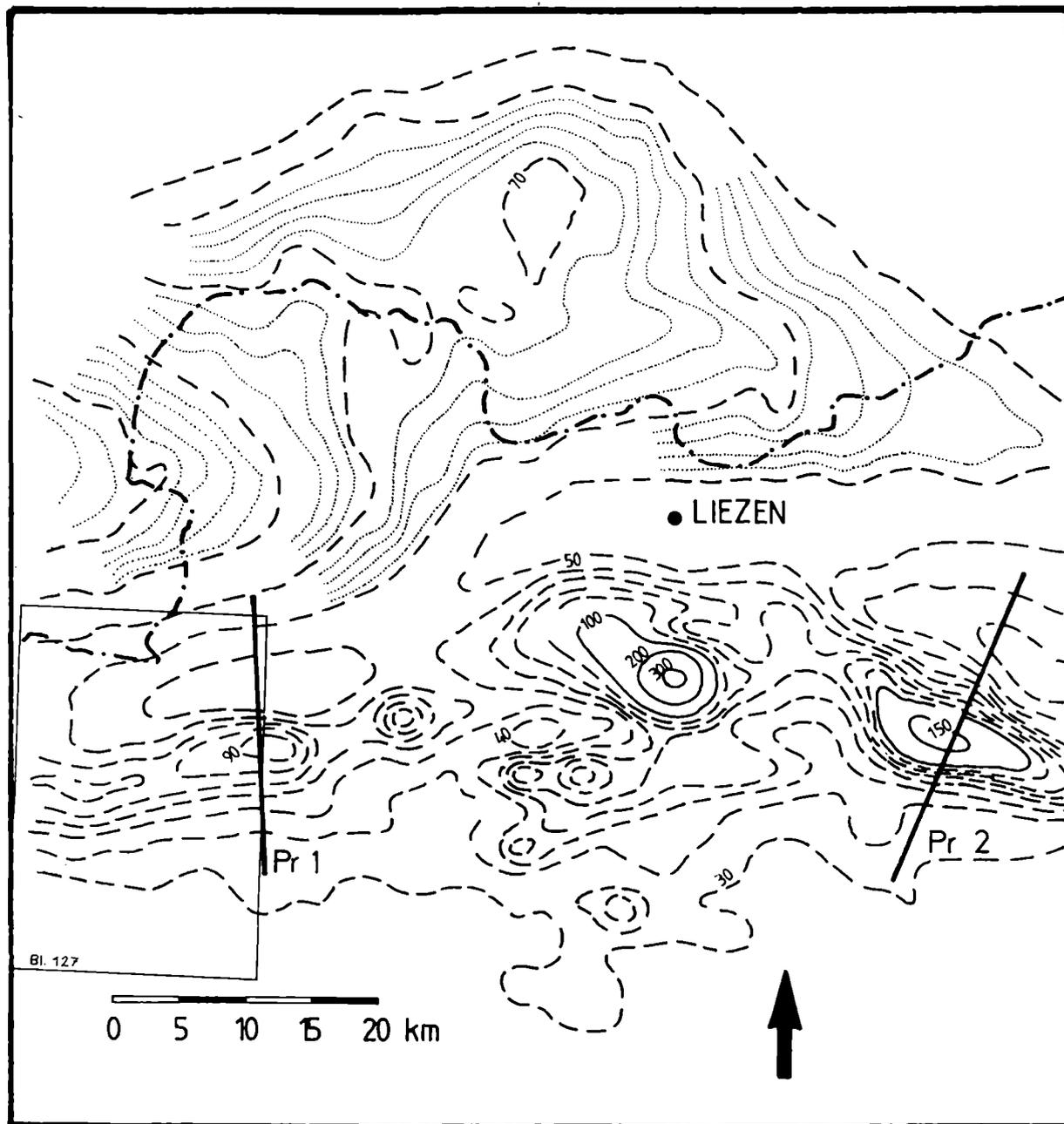
Abb. 12/1: Isoanomalien der Totalintensität (in nT) des Bereiches um Liezen und Lage der Profile 1 und 2
