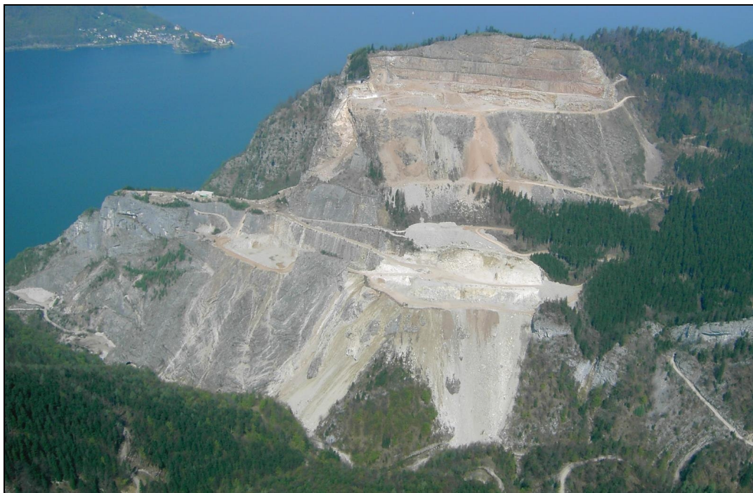
Abb. 2: Steinbruch Karbach 2006 (Luftbild der Fa. MINERAL ABBAU GmbH). Hingewiesen wird auf folgende Änderungen gegenüber 2003: weiter fortgeschrittener Abbau mit der tiefer eingezogenen Etage im Südosten (Alter Abbau; Grenze zwischen Unterlagerung und Plassenkalk [weiß]) und sanierte Kulisse am unteren Westrand des Abbaues Hochlindach.
