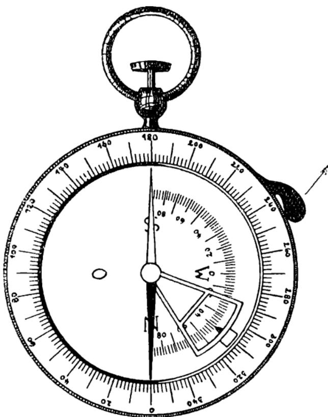
Fig. 3. Klinometer (gleichzeitig Kompaß).
