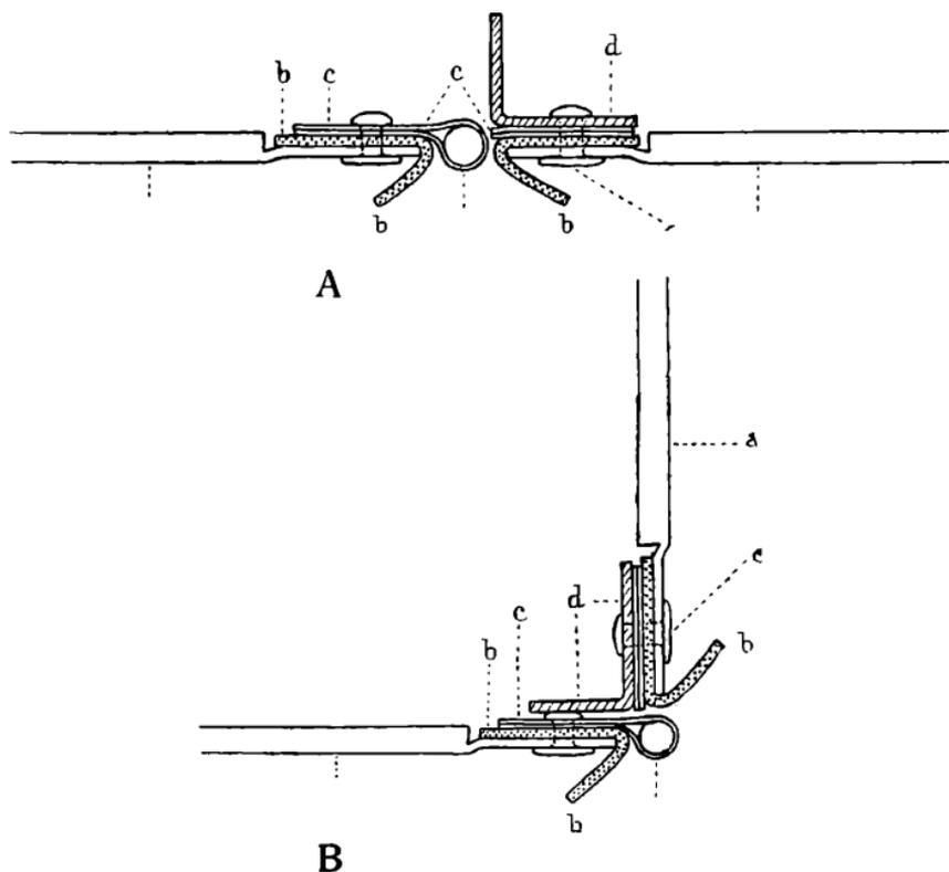
Fig. 1. Ecke des Rahmens, A bei zusammengelegter, B bei gebrauchsfertiger Stellung ( $\frac{1}{1}$ ). a „feste“ Seite des Rahmens, b Metallstückchen, das die „lose“ Seite (nicht eingezeichnet) in Stellung hält, c Scharnier, d Metallstückchen (nur an zwei sich gegenüberliegenden Ecken des Rahmens angebracht), daß die gegenseitige Bewegung der Seiten nur bis zur rechtwinkligen Stellung zuläßt (vgl. A und B), e Nagel.
