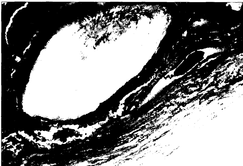
Abb. 54. Wurzelquerschnitt einer Conifere (links), xylitische Lage (rechts unten) und Kutikulen (Mitte diagonal und links oben) kommen durch starke Gelbfluoreszenz (im Bild hellgrau) innerhalb von gelinitischer und ulminitischer Matrix (schwarz) zur Geltung. Weichbraunkohle Apfeldorf. Polierter Anschliff, Blaulichtanregung, Ölimmersion, Ausschnitt 0,15×0,10 mm.
