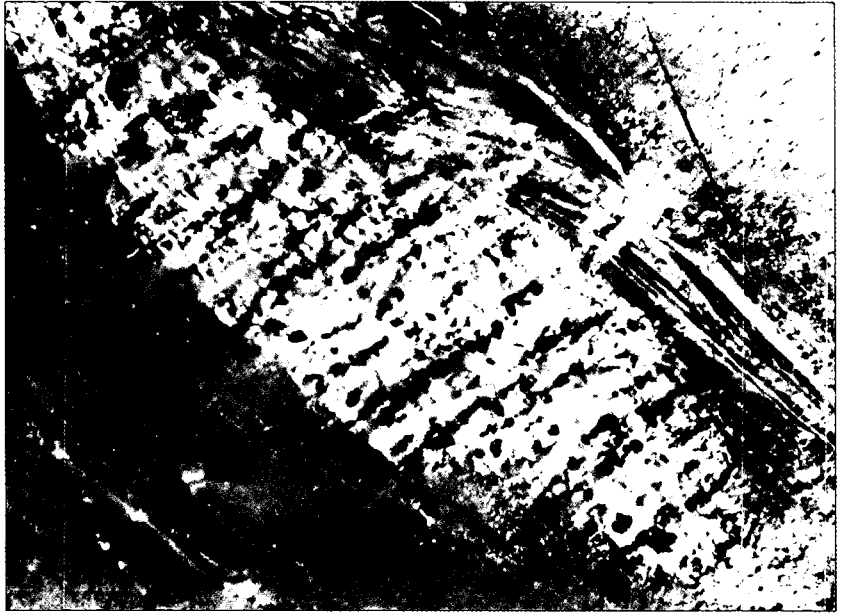
Abb. 10. Semifusinit, mit deutlichen Anisotropieeffekten infolge starker Inkohlung und tektonischer Beanspruchung, als s-parallele Einlagerung in Collinit-Telinit-Lagenbau im Anthrazit des NöBlachjochs. Polierter Anschliff, Nicols x, Ausschnitt 0,64×0,42 mm.
