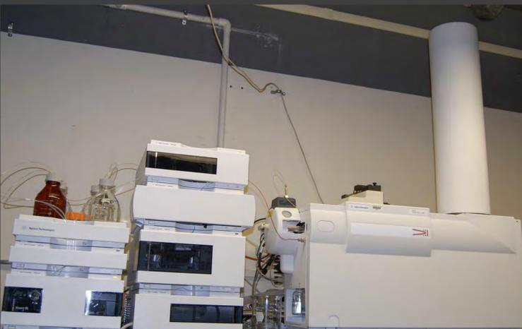
Mehr als 1.000 verschiedene Flechtenstoffe sind bis dato bekannt! Ermöglicht wurde dies durch moderne Methoden zur Strukturaufklärung (organischer) Moleküle. Zu den wichtigsten dieser Methoden gehören Hochleistungsflüssigkeitschromatographie (HPLC) und Massenspektrometrie. Hier im Bild zu sehen ....
