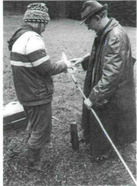
Bohrung mit der kleinen Dachnowski-Sonde
