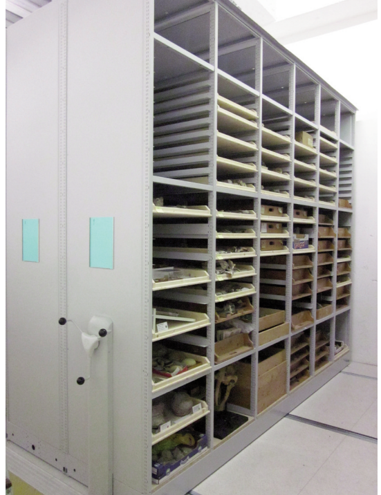
Abb. 2: Die neue Fahrregalanlage für die Paläontologische Sammlung. Während viele der alten Schubladen übernommen wurden, bietet das neue Regal Platz für viele hundert weitere Läden. Die Laufleisten-Höhe kann variabel gestaltet und ideal an die Schubladen- bzw. Objekthöhe angepasst werden. Foto: B. Berning.
