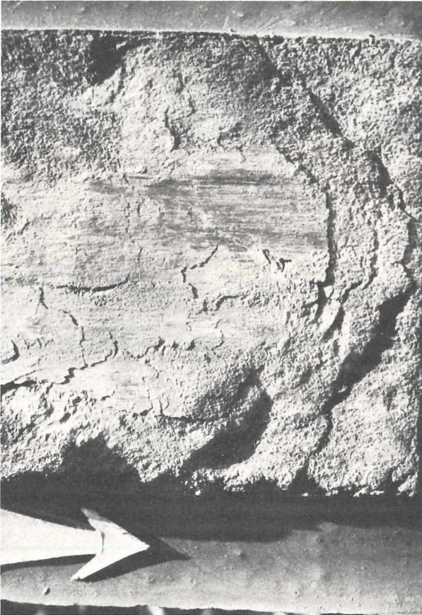
Abb. 7. Aufsicht auf eine künstliche Scherfläche im Annweiler Sandstein. Die Probe wurde mit einer Geschwindigkeit von 1,75 mm/min und mit einer aufgetragenen Normalspannung von 10–20 MPa dextral zerschert. Zu sehen sind die „ecarpments“ der ausstreichenden Riedel shears. Sie sind entgegen der Scherrichtung angelegt (vgl. Abb. 10). Die Größe der Scherfläche beträgt 7 × 7 cm.
