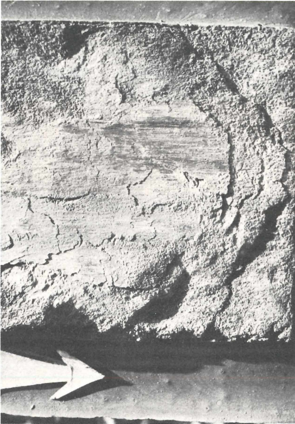
Abb. 7. Aufsicht auf eine künstliche Scherfläche im Annweiler Sandstein. Die Probe wurde mit einer Geschwindigkeit von 1,75 mm/min und mit einer aufgetragenen Normalspannung von 10–20 MPa dextral zerschert. Zu sehen sind die „ecarpments“ der ausstreichenden Riedel shears. Sie sind entgegen der Scherrichtung angelegt (vgl. Abb. 10). Die Größe der Scherfläche beträgt 7 × 7 cm.
