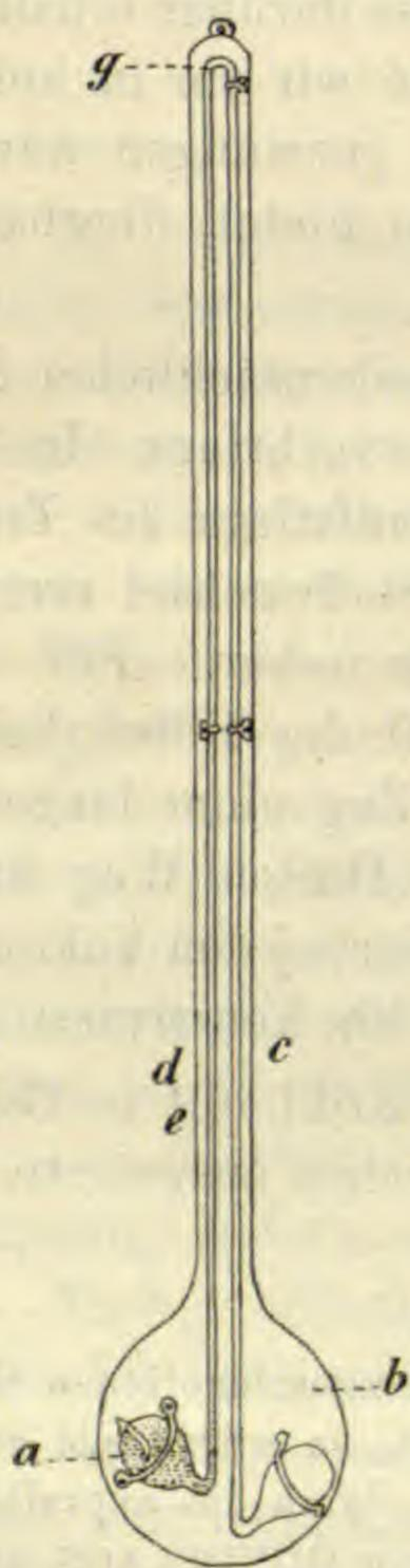
Die Maximalspannung der Flüssigkeit bei diesem Versuche hängt nun von der Länge des Hebers ab. Bei dem zuletzt gefertigten Apparat, mit dem ich operiert habe, beträgt die Länge des aufsteigenden Heberschenkels 1,50 *m*, so dass die Flüssigkeit am Gipfel des Hebers während des Fliessens einem Zuge von etwa zwei Atmosphären ausgesetzt ist. Übrigens kann man sich leicht überzeugen, dass nicht bloss das Quecksilber, sondern auch das Wasser diesen Spannungs-
