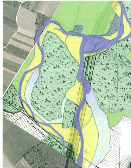
Abb. 5: Altes Flussbett in der Form von drei Flussbettverlagerungen.
