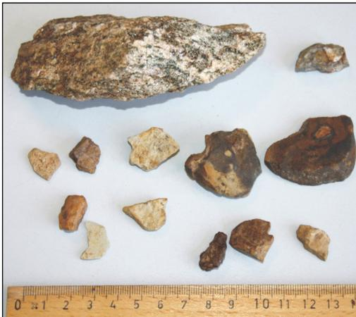
**Abb. 8:** Weitere Lithoklasten aus der Grundmoräne, Aufschlusswand am Fundort: Oben links ein Biotitgneis, oben rechts Feuerstein. Unten: dünnplattige Tonsteinfragmente und koncretionäre Eisenhydroxide (namu ES/qp-36069). Alle Lithoklasten sind kalkfrei.
