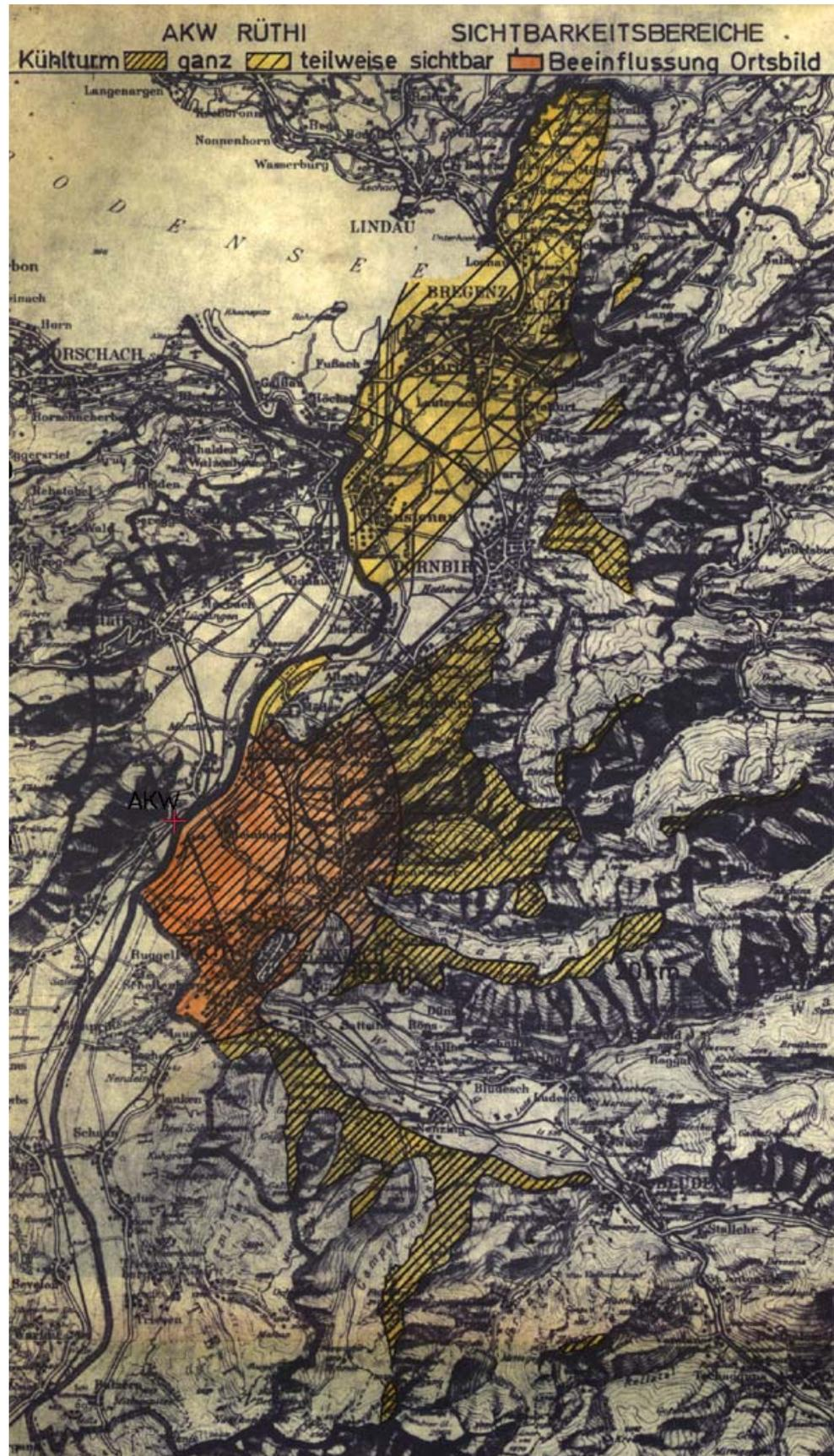
Abb 8: Sichtbarkeitsanalyse zum geplanten Standort des Kühlturms des Atomkraftwerks Rütli – Karte der Vorarlberger Naturschau vom 27.11.1972.
