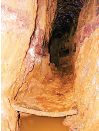
Abb. 24: Links: Sohlenbrett im Bereich der Friedrichstrecke (Frontalansicht). In der Firste schwarze Rußspuren des Feuerstetzens [Foto: Herbener (2012)]. Rechts: Wassersaige (F) nach Agricola [1556] [Quelle: Agricola (1556), S. 95, Ausschnitt]. – Fig. 24: Left: footboard in the area of the Friedrich track (frontal view). In the ridges of the wall, black soot marks of fire settings can be seen [Photo: Herbener (2012)]. Right: "Wassersaige" (F) by Agricola [1556] [Source: Agricola (1556), pp. 95, outcut of the picture].
