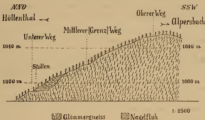
Fig. 1. Profil durch die Anhöhe N. von Alpersbach. Der obere Weg zweigt sich von der Strasse in Alpersbach bei der Kreuzung 1006.9 m ab. Der mittlere Weg bildet gleichzeitig die Gemarkungsgrenze von Alpersbach gegen Hüllsteig und ist auf der topographischen Karte als unterbrochene Linie (— —) eingetragen. Der unten am Stollen vorüberführende Weg findet sich auf der topographischen Karte nicht eingezeichnet.
