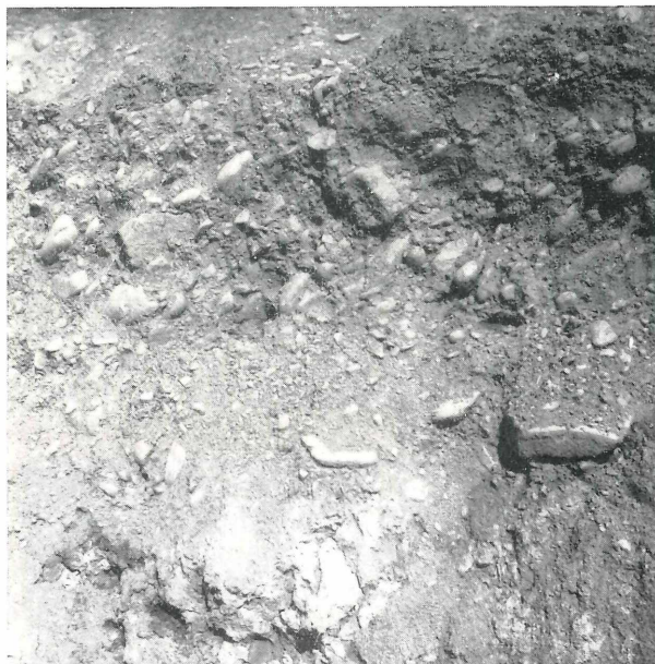
Abb. 2 Ausschnitt aus der Baugrube in Öflingen. Moräne mit z. T. steilgestellten Geschieben über Mergeln.
