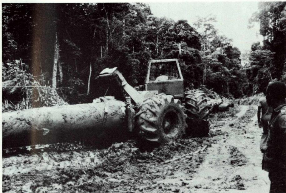
Abb. 6.8: Die früher üblichen Planierraupen werden beim Einschlag von starken Tropenwaldbäumen zunehmend durch sog. *Skidder*, d.h. allradangetriebene starke Knickschlepper abgelöst. Diese weisen eine höhere Marschgeschwindigkeit bei geringeren Kosten auf.
