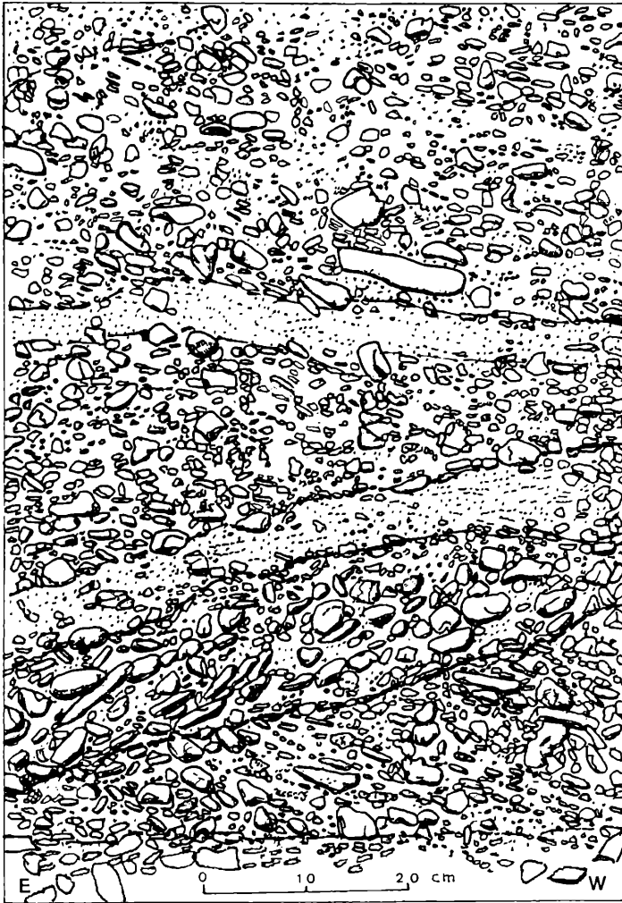
Abb.7: Detail eines Aufschlusses der Kiesgrube Pföhren/Wuhrholz (ca. 671 m NN). Das heutige Oberflächengefälle beträgt nur 1,8 ‰ nach E (links). Stark wechselnde Korngrößen, Fallwinkel und Fallrichtungen belegen dagegen turbulente Sedimentationsverhältnisse wie in einem litoralen Schuttfächer.
