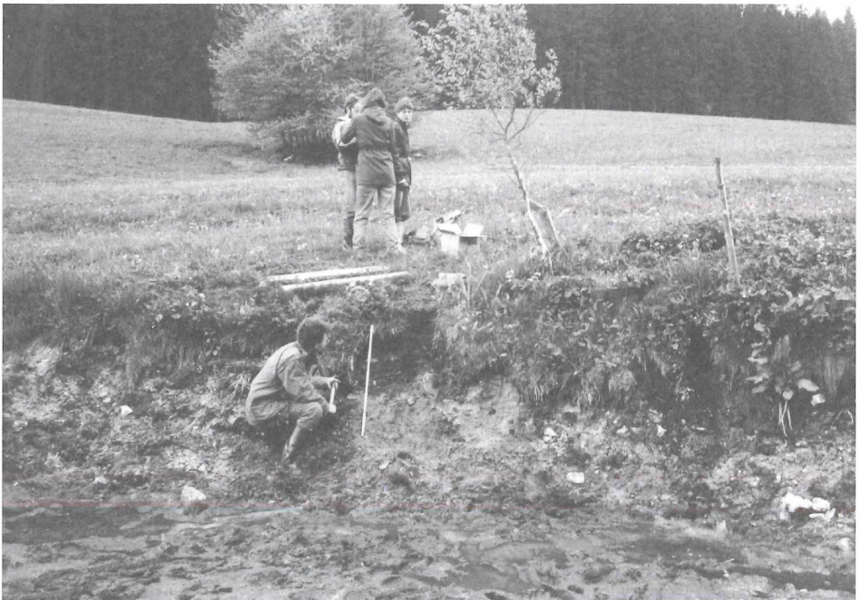
Abb.1: Vermessungs- und Aufschlussarbeiten im schwach geneigten Schiltach-Oberlauf zwischen Lindenbüble und Schmelze. In einer stein- und blockreichen Deckschicht bildete sich Anmoorgley (Photo: R. Mäkel)
