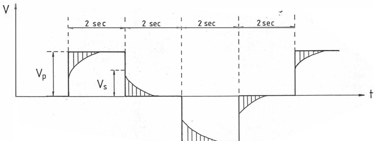
Abb.A2: Der I.P.-Effekt bei Zeitbereichsmessungen
