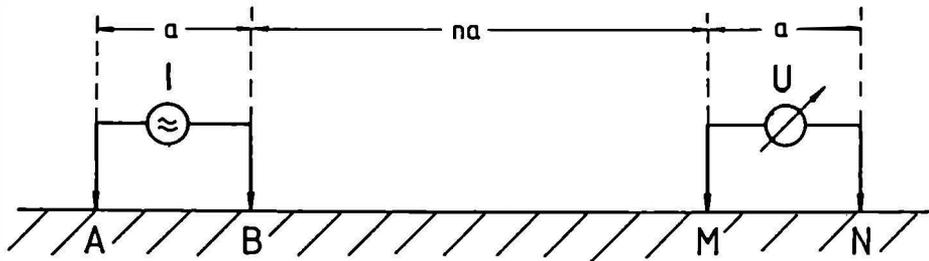
Abb.A1: Die Dipol-Dipol Meßanordnung
