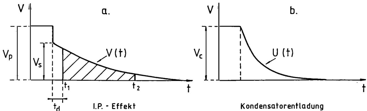
Abb.A3: Der Vergleich zwischen dem Abklingen des I.P.-Effekts und einer Kondensator-entladung.
