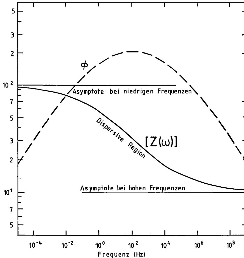
Abb.A4: Das Frequenzverhalten des scheinbaren spezifischen Widerstandes
