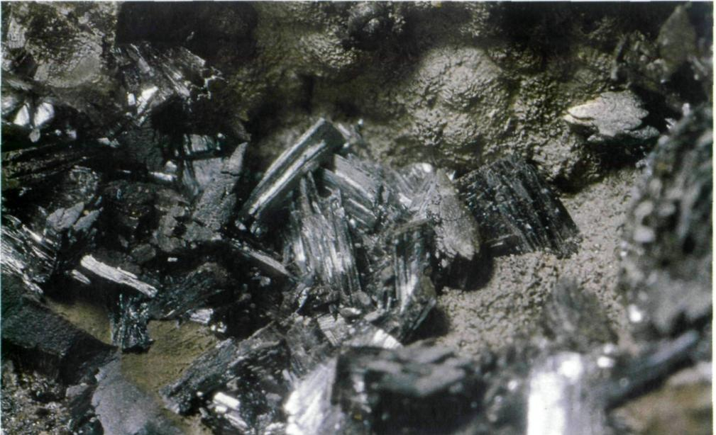
Rancieit, überwiegend vermengt mit Todorokit, bildet stanniolartige, goldig-bräunliche Aggregate. In Schichten aufgebaute, dichte, weiche, bis 1 cm dicke, dunkelbraune Beläge auf Goethit bestehen aus schlecht kristallisierten Mn-Oxiden/Hydroxiden (i. w. Todorokit) und Calcit. In Hohlräumen dieser Vererzungszonen sind farblose oder bräunlich gefärbte Calcitrhomboeder mit über 10 mm Kantenlänge zu finden.
