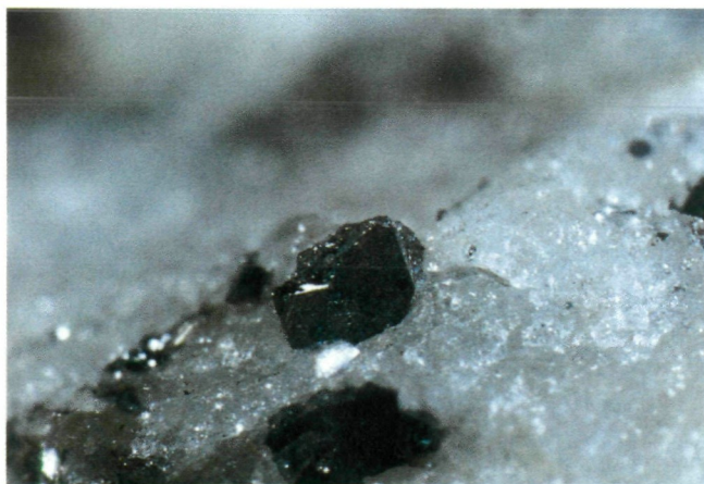
Abb. 16: In Gangquarz eingewachsene Gersdorffit-Erzkörner. Fundort ist die Molybdänvererzung an der Feldsee Scharte im Wurtengebiet, Kärnten. Bildbreite 4 mm. Foto: H.-W. Graf.
