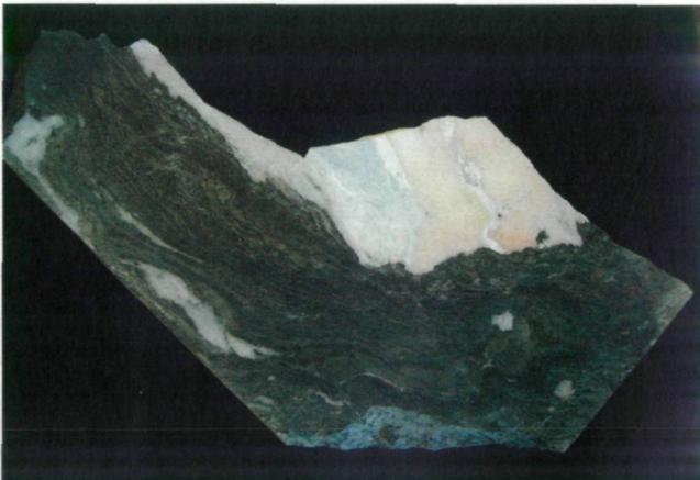
**Abb. 3:** Mit bläulichem, Sr-reichem Baryt mineralisierter Marmor, als vermutlich vulkanoklastische Einlagerung in Metadiabas aus dem Steinbruch der Firma Kogler in St. Urban-Stattenberg. Sammlung und Foto: NHM Wien
