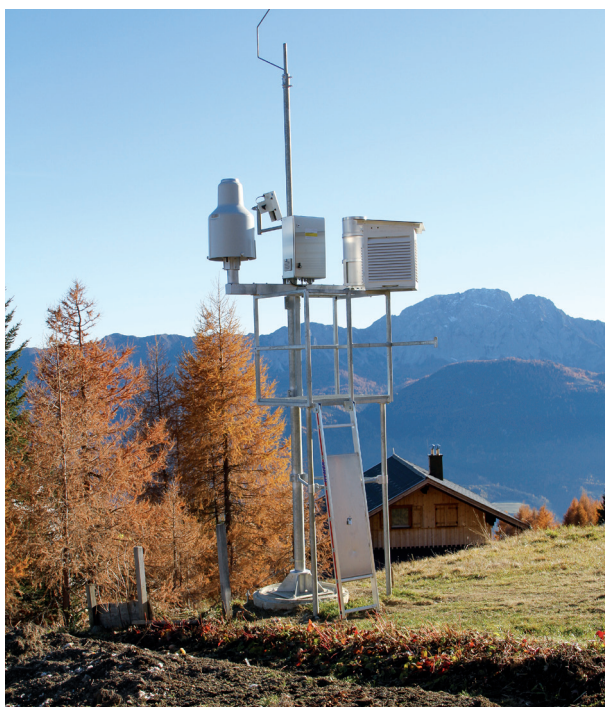
Abb. 18: Niederschlag-Messstation Emberger Alm; Seehöhe 1740 m üA; Foto: Ljuba; Hydrographischer Dienst Kärnten; (Messausstattung: Niederschlagswaage, Ombrometer; Lufttemperatursensor, Schneehöhenlaser. Internet: www.wasser.ktn.gv.at/hydrographie
