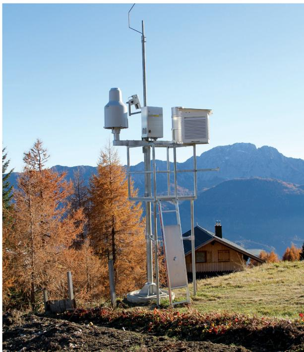
**Abb. 18:** Niederschlag-Messstation Emberger Alm; Seehöhe 1740 m üA; Foto: Ljuba; Hydrographischer Dienst Kärnten; (Messausstattung: Niederschlagswaage, Ombrometer; Lufttemperatursensor, Schneehöhenlaser. Internet: [www.wasser.ktn.gv.at/hydrographie](http://www.wasser.ktn.gv.at/hydrographie)
