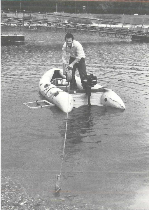
Abbildung 5. Langsames Zurückziehen des Bootes an der Meßleine; dabei wird die Uferentfernung alle Meter abgelesen.
