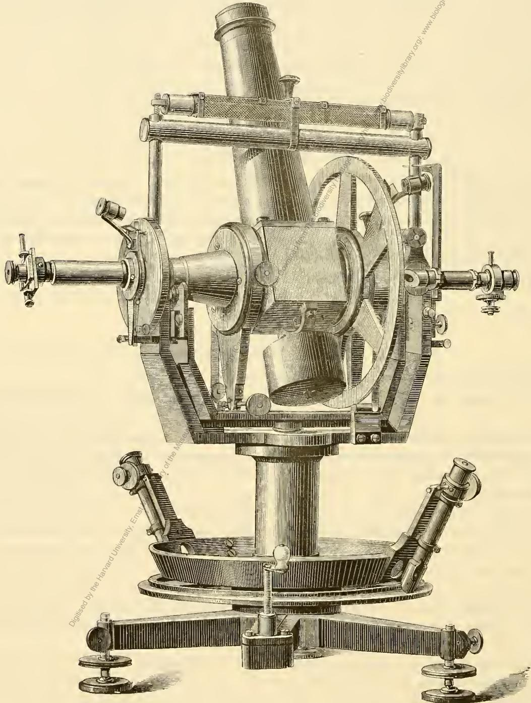
beiden Kreisen direct von 5 zu 5 Bogeminuten durchgeführt; sie wird mittelst der diametral gegenüberstehenden Mikroskope abgelesen. In jedem derselben befindet sich ein beweglicher Doppelfaden, welcher ein
