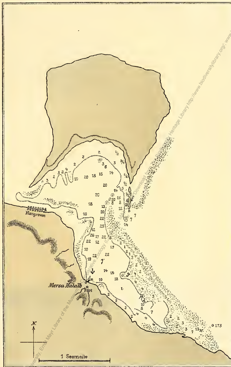
Wasserschöpfstellen \alpha - \mu im Korallengebiet von Mersa Halaib an der afrikan. Küste. Tiefenangabe in engl. Faden ..... Fünffadenlinie 1 Faden = 1,83 m. ~~~~~ Korallenbildungen
