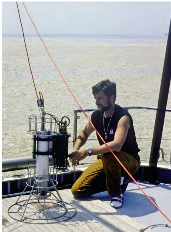
**Abb. 58:** Ein sogenannter Multiscanner wurde ins Meer gesenkt und in verschiedensten Tiefen Messungen durchgeführt. Die Daten wurden über Kabel auf der Brücke im Computer in Echtzeit dargestellt und abgespeichert.
