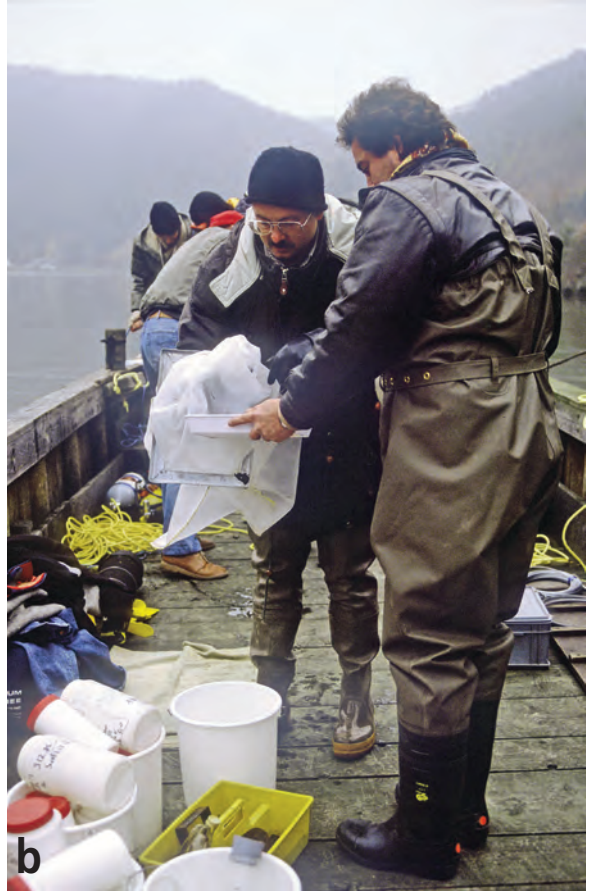
Abb. 43: (a) Ein Signalmann für Leinensignale, und ein Seilmann zur Sicherung und Hebung des Proben-Entnahmegertes arbeiteten an der Oberfläche. Das Schiff Melk stand während der ganzen Operation frei mitten im Strom unter Motor, die Taucher seilten sich in der Strömung seitlich am Schiff vorbei zum Donaugrund ab. (b) Der erste Sampler ist erfolgreich an Bord gezogen und wurde von Otto Moog (links) übernommen. (c) Otto Moog (links) entnahm die Probe aus dem Sampler und sichtet sie. Das Material wurde anschließend gleich vom Team fixiert.
