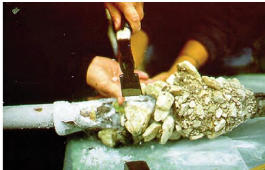
**Abb. 13:** Nachdem der tiefgefrorene Eis-Sedimentklotz aus dem Bachbett gezogen wurde, kann er für die weitere Analyse des Sediments, des Porenraumes und der Bachorganismen in Portionen zerlegt werden.
