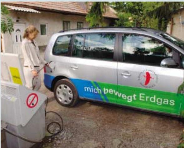
BETANKUNG MIT ERDGAS – Kompression auf 80 bar im Stahl-Drucktank des Touran. Die Haustankstelle ist bequem – doch das öffentliche Gas-Tanknetz wächst. Wer mit Methan fährt, ist nicht nur umweltfreundlicher unterwegs, er berappt auch weniger für den (landschaftszerstörenden) Straßenbau.
