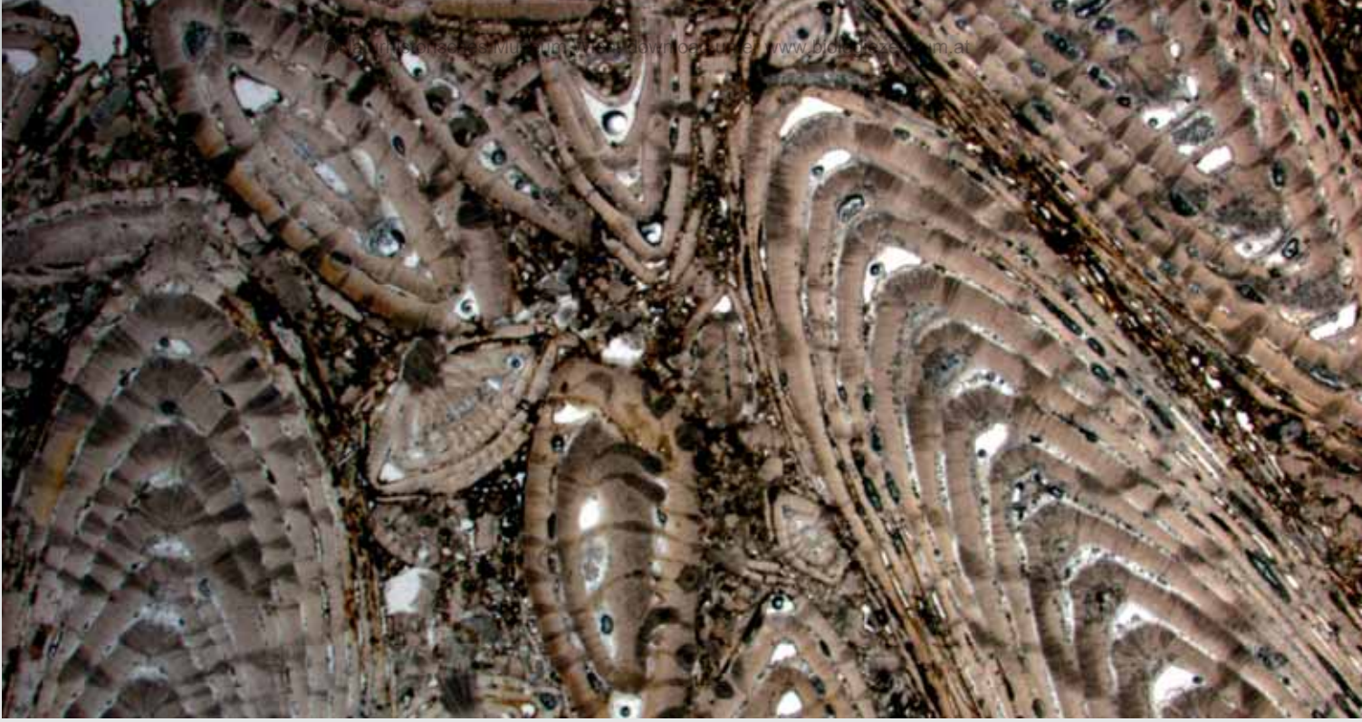
DÜNNSCHLIFF DURCH EINEN BAUSTEIN DER PYRAMIDEN IN GIZEH Die Probe gelangte bereits im späten 19. Jahrhundert ans Naturhistorische Museum. Das etwa 50 Millionen Jahre alte Gestein besteht aus Nummuliten, die die größten Einzeller hervorbrachten, die je gelebt haben.
