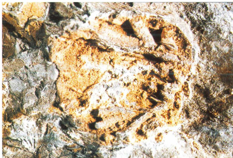
Abbildung 4. Ausgefüllte Bohrgänge in einer herausgewitterten Brachiopoden-Schale. Tunnelbaustelle Aegidienberg, Aeg 10 lateral. 5-fach vergrößert.
