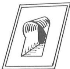
Abb. 11: Blechziegel sollten vom Klempner hergerichtet werden.
