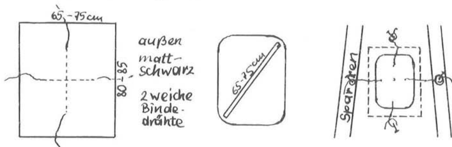
Abb. 3: Eine Hartfaserplatte deckt vorübergehend die Turmfensteröffnung ab.
