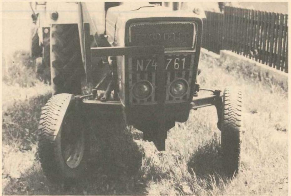
Befestigungsmöglichkeit für Auslegerarm einen Meter vor der Kühlermaske.
