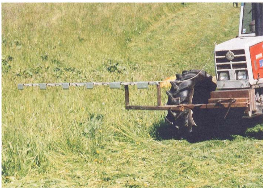
Auslegermontage am Traktor. Die Sensoren sind durch Schutzbleche verdeckt.
