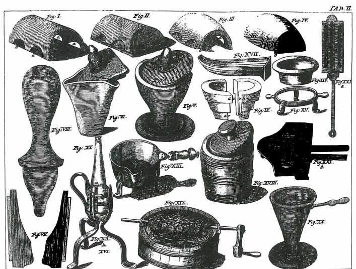
Abb. 4: Laborgeräte (GELLERT, 1750): Kapellen Fig. I–IV, Tute Fig. V, Tiegel Fig. VI.
