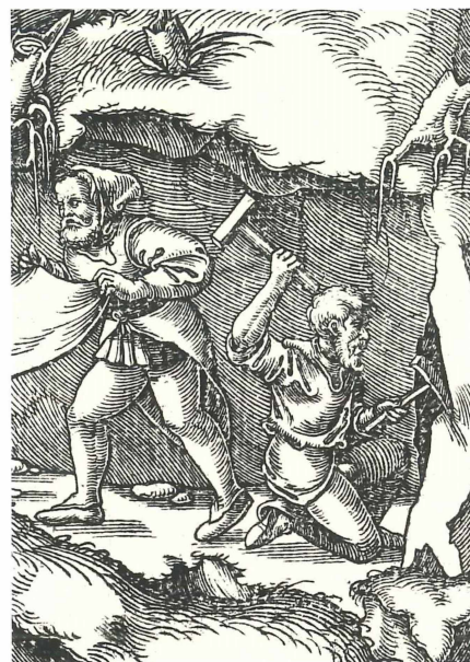
Abb.8: Bergmann bei der Arbeit mit Schlägel und Eisen. Nach einem Holzschnitt aus Phillip Bechius (1557); mit freundlicher Genehmigung nach dem Exemplar des Referats für Geologie und Paläontologie am Landesmuseum Joanneum.
